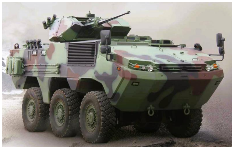
Blindado VCI ARMA II de Turquía, se aprecia la torre, estación remota RVS con el cañón de 30 mm.
