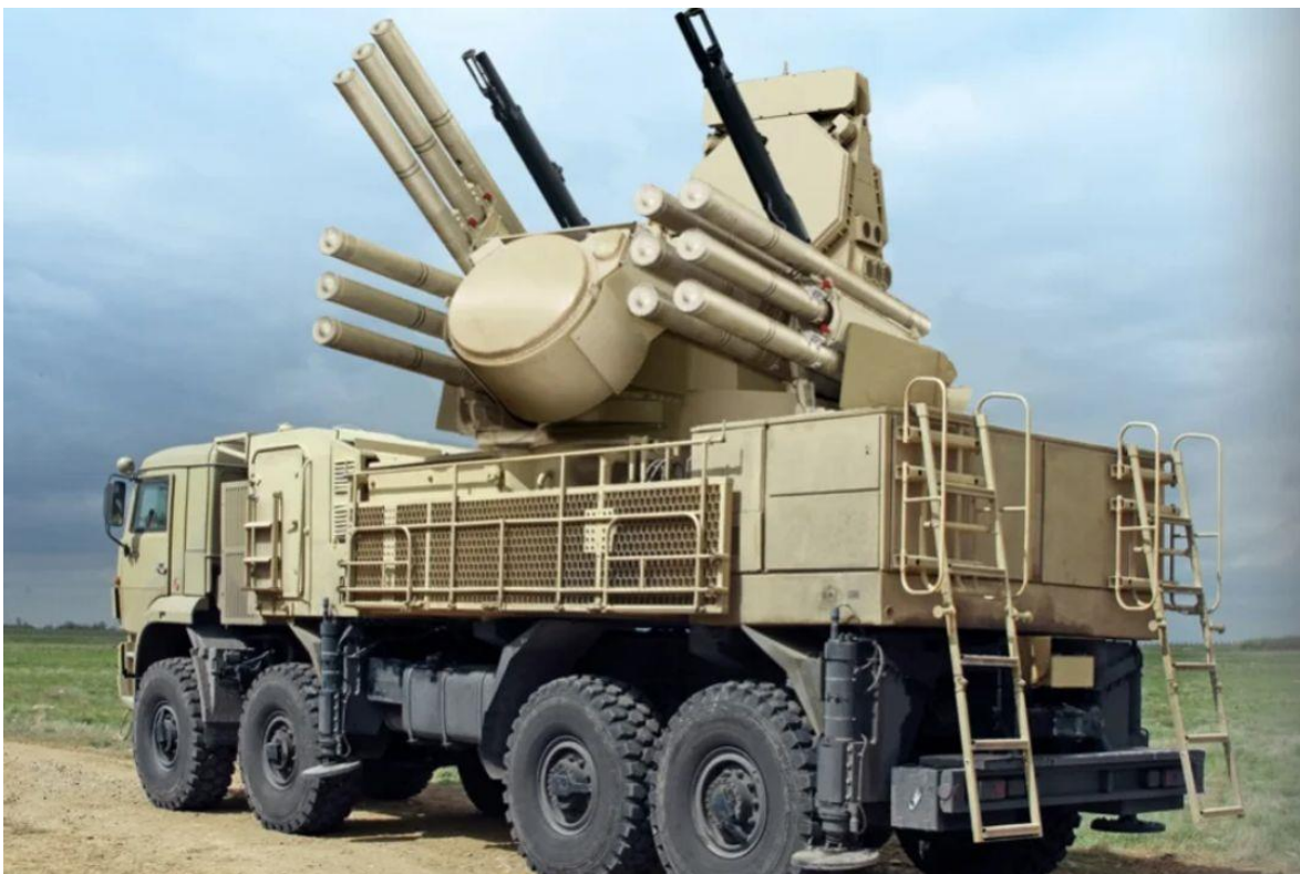
Sistema Antiaéreo Ruso, entregado a Venezuela PANTSIR-S1, sistema mixto de misiles y artillería balística, anti-naves (aviones y helicópteros) y anti-drones, de corto y mediano alcance.
